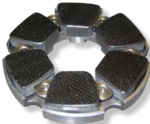
Армированный волокном керамический самоустанавливающийся упорный сегментный подшипник диаметром 110 мм (4,3 дюйма), используемый в уплотнении высокотемпературных ПЭН.
