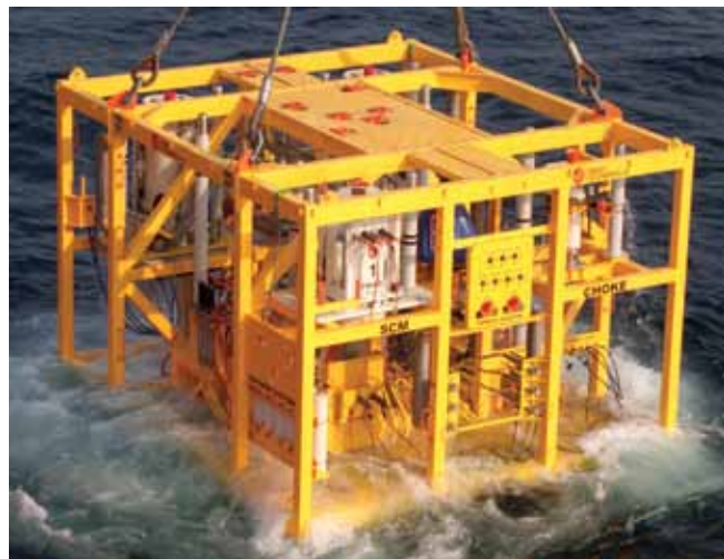
Морской глубинный модуль состоящий из двух насосов для нагнетания воды с полимерными самоустанавливающимися упорными и опорными сегментными подшипниками. (Фотография любезно предоставлена компанией Framo Engineering AS.)
