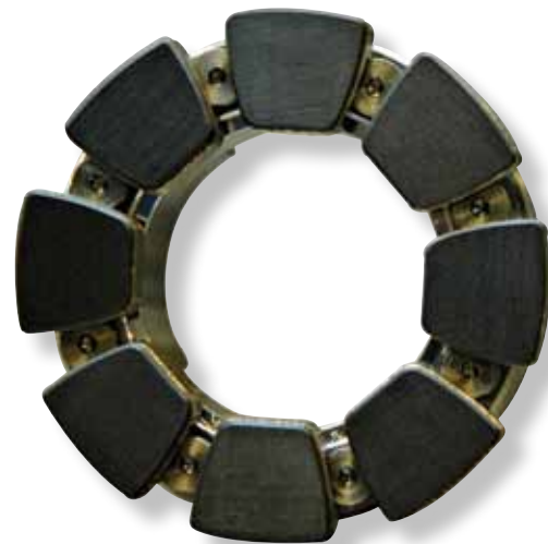
Самоустанавливающийся упорный сегментный подшипник с полимерным покрытием и наружным диаметром 62 мм (2,5 дюйма), используемый в электродвигателе ПЭН.
