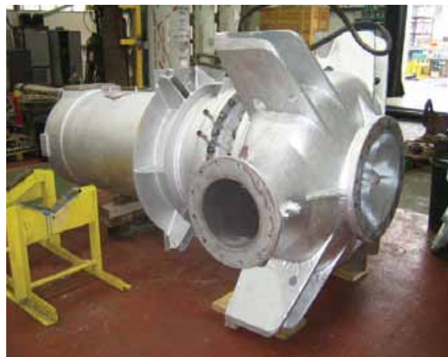
В настоящее время перекачивающие насосы нагревателей, изготовленных по технологии «мокрой намотки» и применяемых на крупных электростанциях, модернизируются путем замены подшипников из материала «ferrobestos» на цельнополимерные упорные подшипники. (Фотография любезно предоставлена компанией Framo Engineering AS.)
