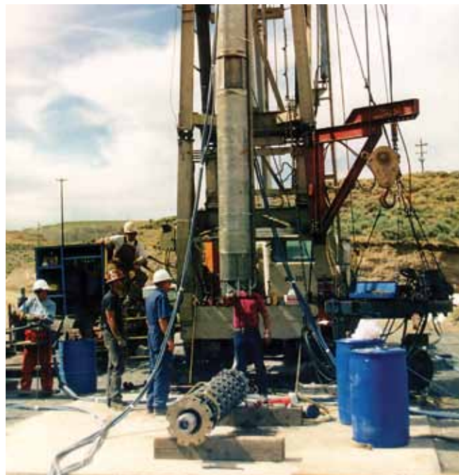
Водонаполненный электродвигатель мощностью 2200 л.с. с керамическим упорным подшипником, эксплуатирующийся на золотом прииске в штате Невада.
