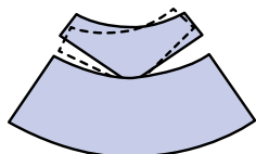
Стандартные подшипники с самоустанавливающимися сегментами
