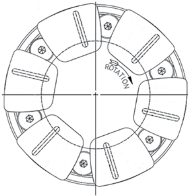
Hidrax 和 Hidrax HT 轴承提供 中心或偏心支撑选择
